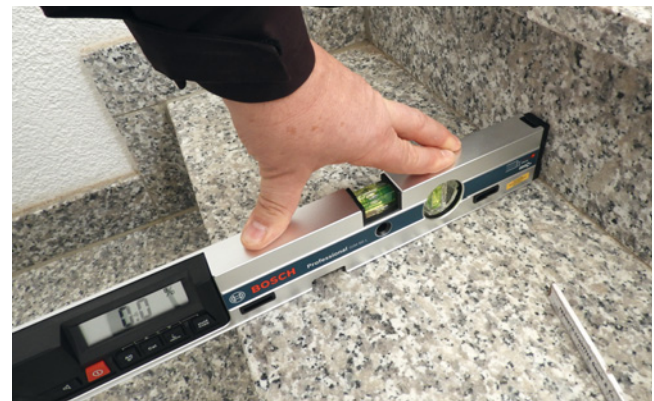
Die Messung ergab 0% Gefälle. Das widerspricht der Vorschrift.
